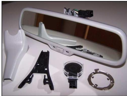
Die obere Abbildung zeigt einen automatisch abblendbaren Innenspiegel mit großer Fassung. In der unteren Abbildung sind die zwei verschiedenen Ausnahmen abgebildet. Wobei beim nachrüsten die meisten, zumindest bis zum MJ06 die kleine Aufnahme brauchen werden, wie es bei neueren MJ aussieht, kann ich nicht sagen.
