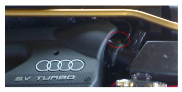
Nachdem alles fertig montiert ist, nehmt ihr die neue Bremsflüssigkeit und füllt sie mit Hilfe eines Einfülltrichters ein. Wie viel genau kann ich nicht sagen...ist aber nicht mehr als 0,5L. Füllt einfach nach und nach ein, beim Entlüften ab und zu mal ein Blick auf den Stand der Flüssigkeit werfen und eventuell nachfüllen.
