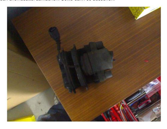
Als nächstes wechselt ihr die Beläge aus, dazu eine kurze Erläuterung: Auf dem Bild seht ihr die beiden Beläge, dort wo der Stecker dran hängt – das ist der innere Bremsbelag. Dahinter ist ein Kolben, welcher mit Hilfe der Bremsflüssigkeit betrieben wird. Problem ist, die neuen Beläge sind dicker als die alten.
