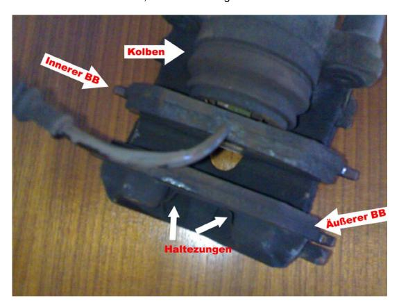
Würdet ihr die Beläge nur tauschen, so würde der Sattel samt neuen Belägen nicht auf die Scheibe passen. Ihr müsst das Luftablassventil lösen [siehe Bild, 2 Seiten drüber, unter "1. Ventilschraube"], den Kolben nach außen drücken und so platz schaffen. Dann hebelt ihr die alten Beläge raus (sind nur geclipst – siehe oberes Bild "Haltezungen") und tut die neuen rein (Bevor die neuen rein kommen, erst den Sattel putzen, siehe nächste Seite).
